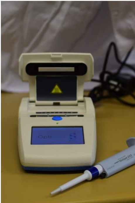
1. ábra: LAMP vizsgálathoz használt Genie® III. műszer /KENESSEY 2017/.
